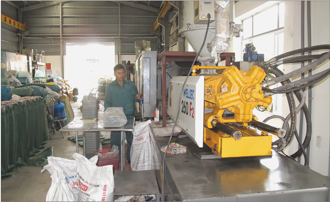
Doanh nghiệp tư nhân cơ khí Thiên Văn đầu tư hệ thống máy ép nhựa tự động hóa có hiệu suất cao và tiêu tốn ít điện năng.
