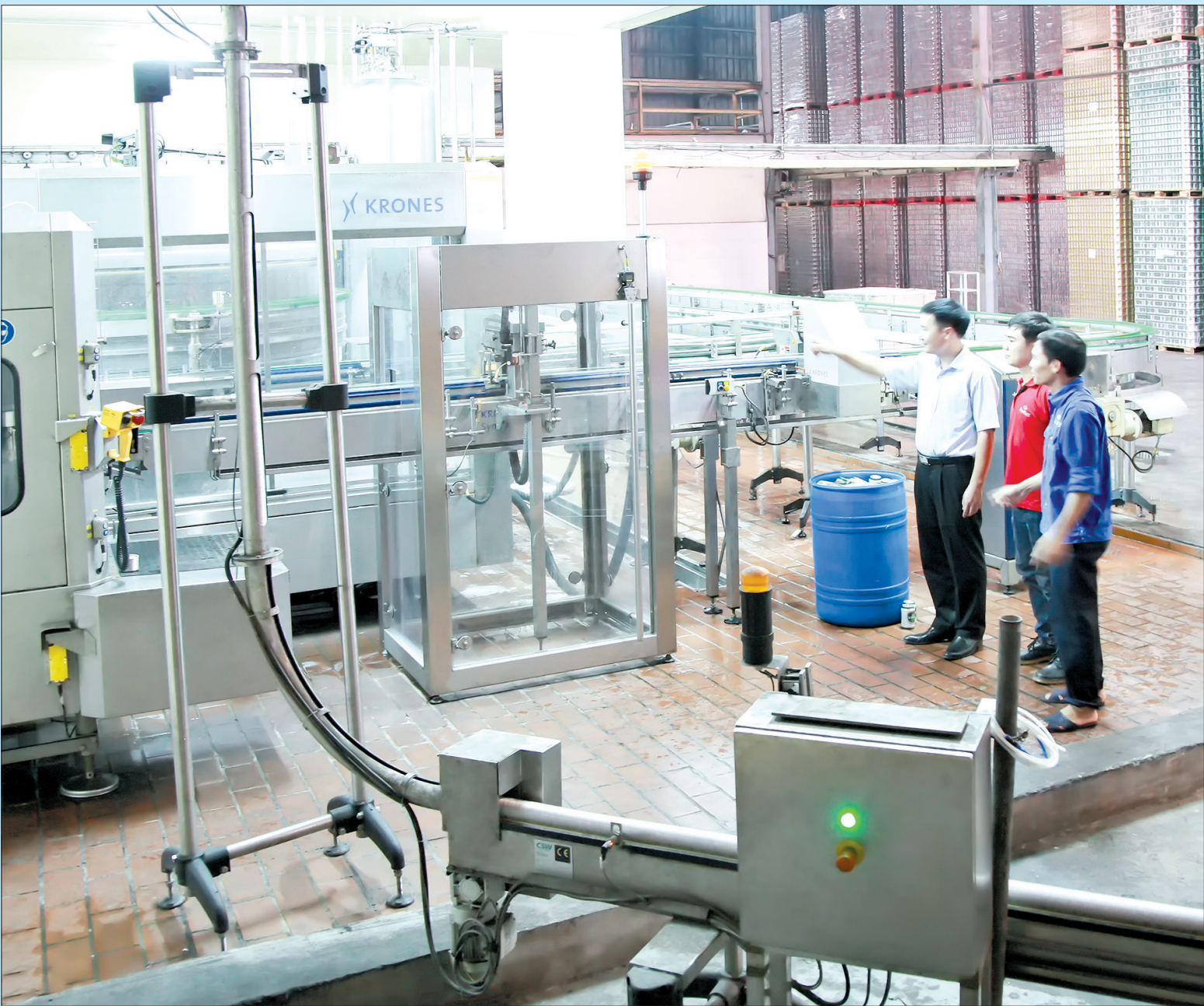
Dây chuyền chiết lon, đóng hộp tự động công suất 50.000 lon/giờ do Thạc sĩ Trần Văn Trà (Công ty Cổ phần Tập đoàn Hương Sen) cải tiến, chế tạo.
